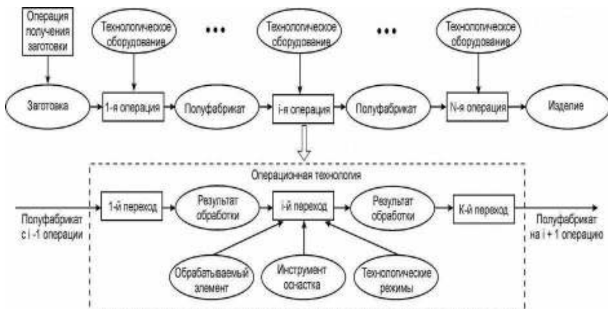
Рис. 213. Структура технологического процесса
