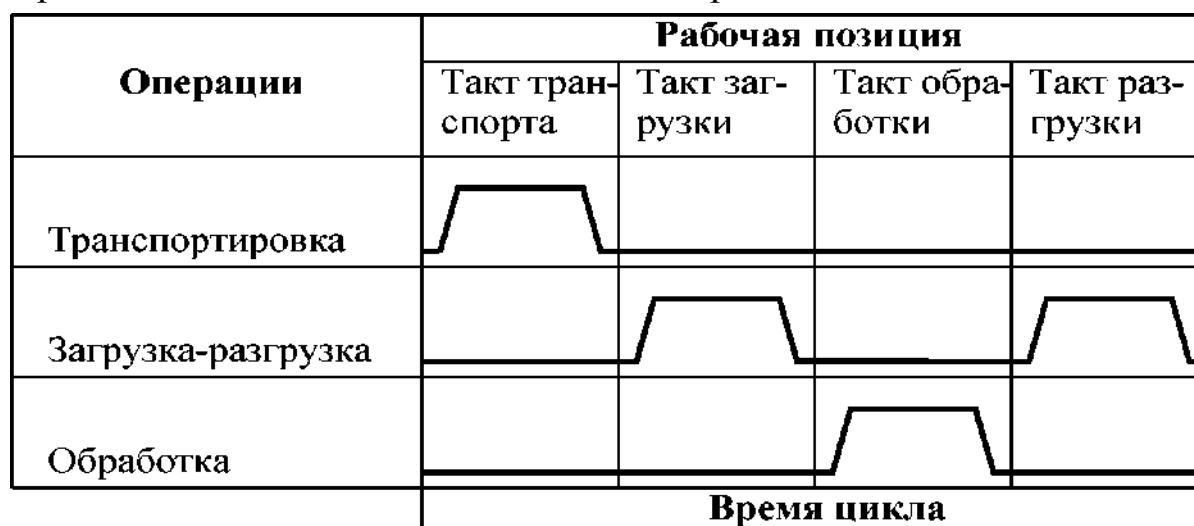
Рис. 15. Циклограмма автоматической линии
